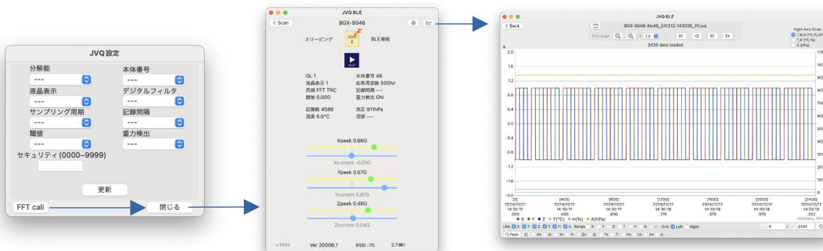
FFTモードで FFT cali をクリック → JVQ設定を閉じ → FFT計測 START/STOP → Chartを開く XYZの矩形波軸別の成分
